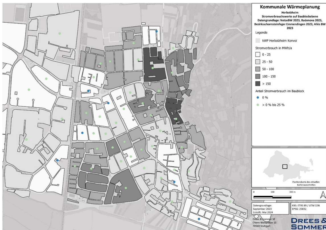
Abbildung 30: Heizungsstrom mit Anteil im Baublock (Ausschnitt Herbolzheim)
